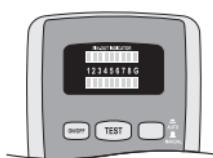
Le testeur de câbles vous permet de contrôler le bon fonctionnement et le câblage correct des lignes de réseau (contrôlez à cet effet l'affectation correcte des broches des différents systèmes de câbles).
