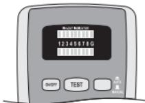
Mit dem Kabeltester können Netzwerkleitungen auf Funktion und richtige Beschaltung hin geprüft werden (Beachten Sie dazu die entsprechenden Pinbelegungen der verschiedenen Leitungssysteme).
