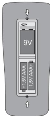
Lassen Sie keine Verbrauchten Batterien im Messgerät, da selbst auslaufgeschützte Batterien korrodieren können und dadurch Chemikalien freigesetzt werden können, welche Ihrer Gesundheit schaden bzw. das Gerät zerstören.
