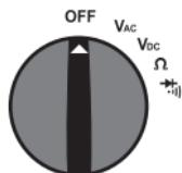
De afzonderlijke meetfuncties kunnen via de draaiknop worden ingesteld. Het meetapparaat is op stand „OFF“ uitgeschakeld. De kabeltester wordt met de toets „ON/OFF“ in- en uitgeschakeld.
