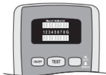
Met de kabeltester kunnen netwerkkabels op werking en juiste bedrading worden getest (neem hiervoor de desbetreffende pintoewijzingen van de verschillende kabelsystemen in acht).
