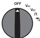
Die einzelnen Messfunktionen können über den Drehschalter eingestellt werden. Das Messgerät ist in Position „OFF“ ausgeschaltet.
