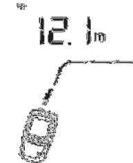
Obrázek 20. Přerušený koaxiální kabel
