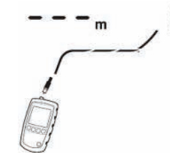
Obrázek 22. Neznámé zakončení koaxiálního kabelu
