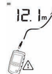
Obrázek 21. Zkrat na koaxiálu
