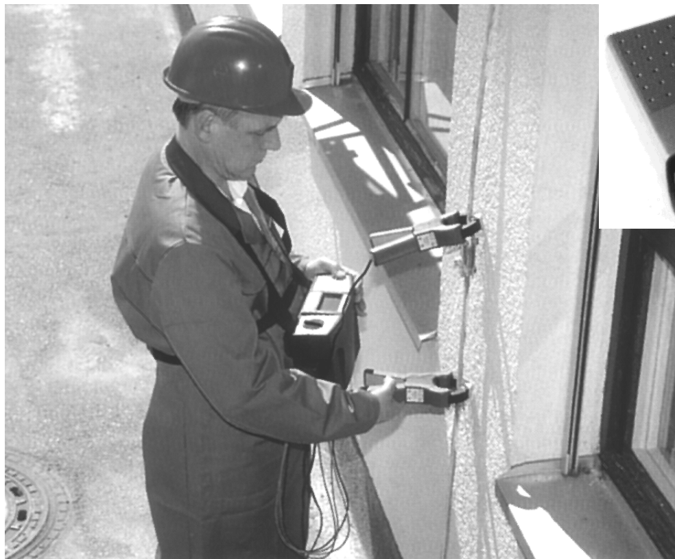
Měření zemního odporu bez rozpojení
